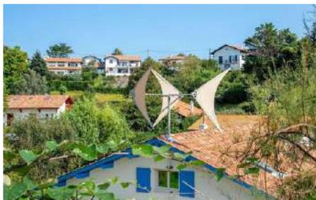
Micro-éolien installé sur toiture d'habitation, hélices en voile à rotation horizontale
